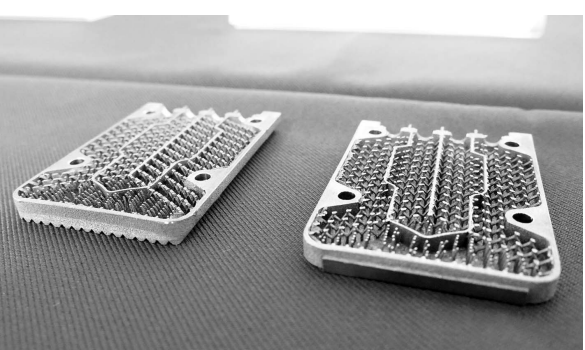
ダイヘンが開発した3Dプリンター製の銅ヒートシンク
