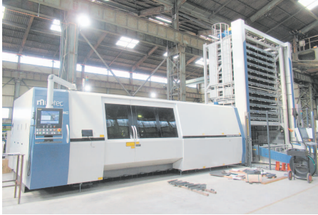
村田機械製のファイバーレーザー複合加工機「LS3015MC」と12段ストックシステム
